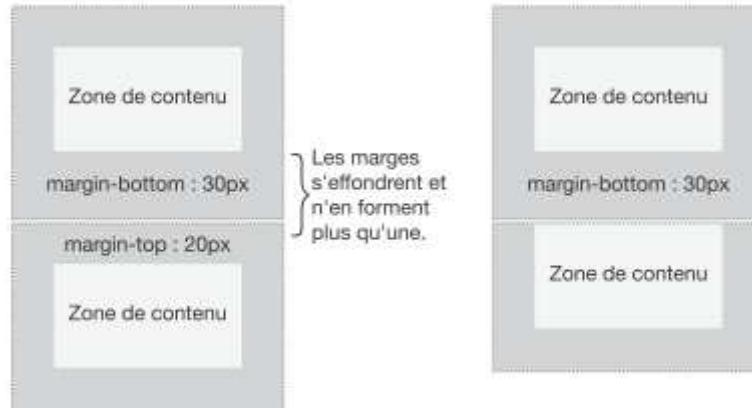
Cet effet nous permet de s'assurer que lorsqu'un élément est le premier ou le dernier d'un groupe, il puisse être maintenu éloigné du haut ou du bas de la page de l'élément conteneur (ici, le body).
