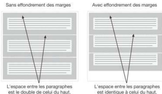
**L'effondrement des marges ne se produit qu'avec les marges verticales des boîtes de bloc dans le flot normal du document.** Les marges entre les boîtes incorporées dans les lignes, flottantes ou positionnées de manière absolue, ne s'effondrent jamais. Les marges internes ("padding") ou des contours ("border") ne génèrent pas le même phénomène.
